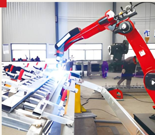
PLANTA EN CHINA · SOLDADURA DE MARCOS DE ACERO
